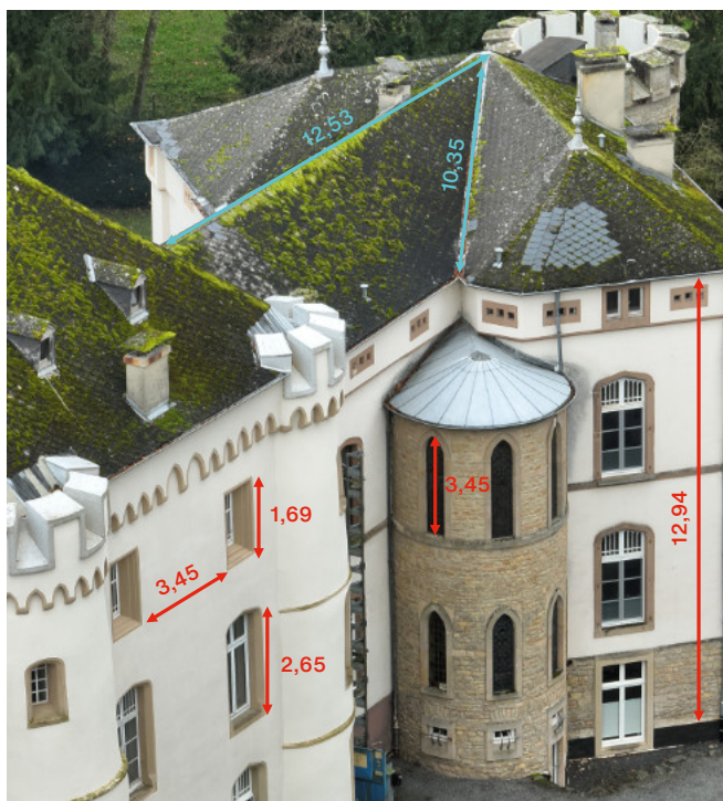
Aus schräg aufgenommenen Luftbildern lassen sich einzelne Elemente eines Gebäudes exakt vermessen (Quelle: ISU GmbH)
